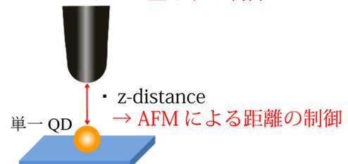
図 1 AgTip を駆使した単一 QD の発光光子統計制御の模式図
